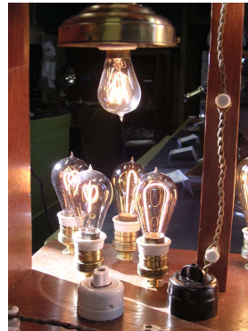
Lampe à arc et ampoules à filament de carbone (qui ont plus de 100 ans) en fonctionnement.
