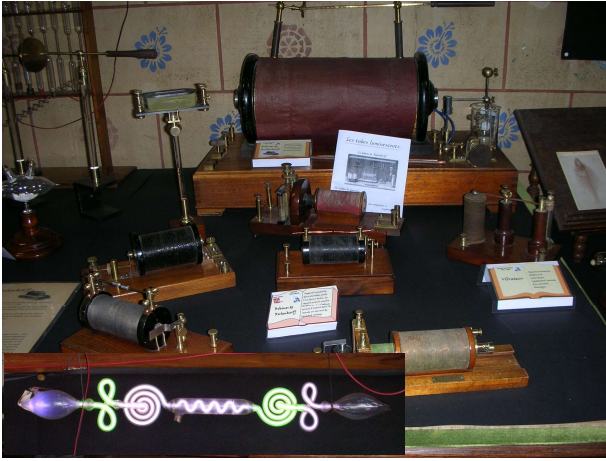
Bobines de Ruhmkorff et tubes à décharge.
